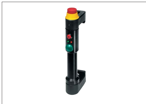
Fig. 5: Con el interruptor de empuñadura TG el usuario tiene, no sólo todos los elementos esenciales de mando, en la empuñadura, sino que también tiene información del estado en que se encuentra, el dispositivo de protección.
