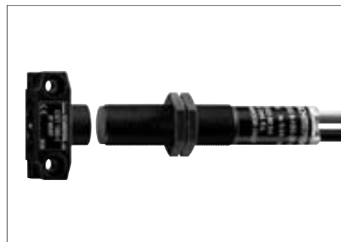
Afbeelding 4: Op de SPS/ IPC/ Drives beurs stelde Schmersal de serie CSS 180 voor: een veiligheidssensor met een nieuw werkingsprincipe. Tot zes CSS 180 kunnen in serie geschakeld worden zonder afbreuk te doen aan het veiligheidsniveau (tot categorie 4 volgens EN 954-1).
