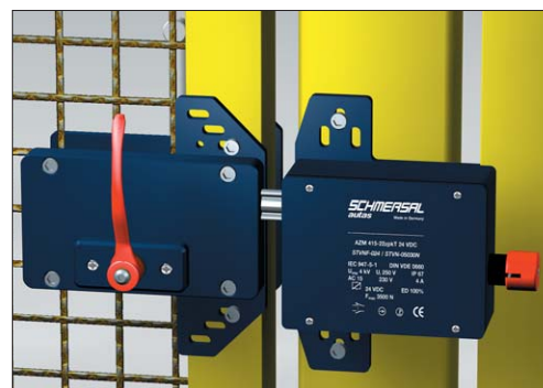
Afbeelding 1: Voor beschermvoorzieningen die met veiligheidsvergrendelingen uitgerust zijn, moeten veiligheidsmodules gebruikt worden die de toegang tot de gevarenszone pas vrijgeven na volledige stilstand van de gevaarlijke beweging.
